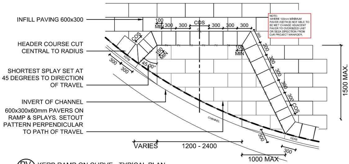
**PV 4.7** KERB RAMP ON CURVE - TYPICAL PLAN
