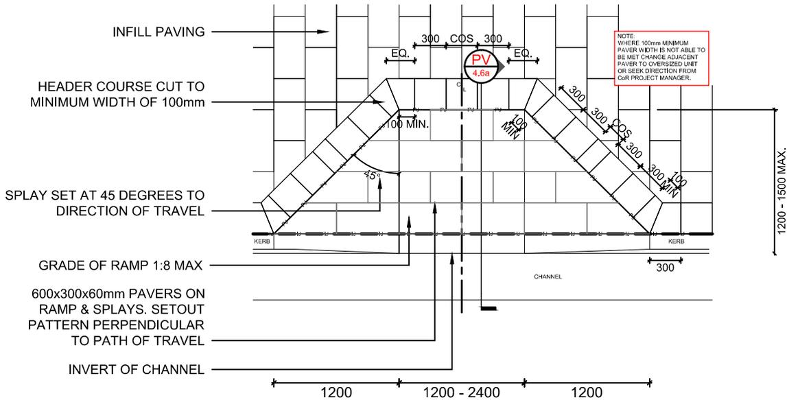
**PV 4.6** KERB RAMP PLAN - TYPICAL
