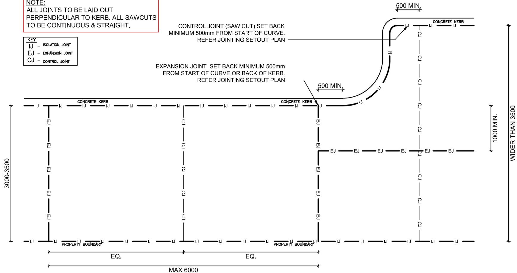
**PV** CONCRETE SLAB JOINT SETOUT - TYPICAL
